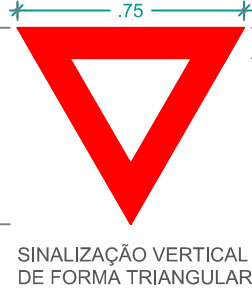
DETALHE PLACA ESC. 1:25
